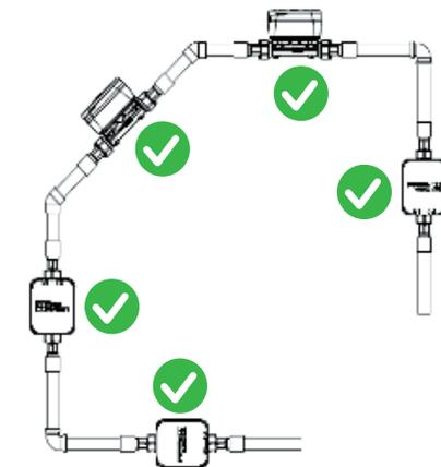
Fig. 1.4. positions d'installation possibles
