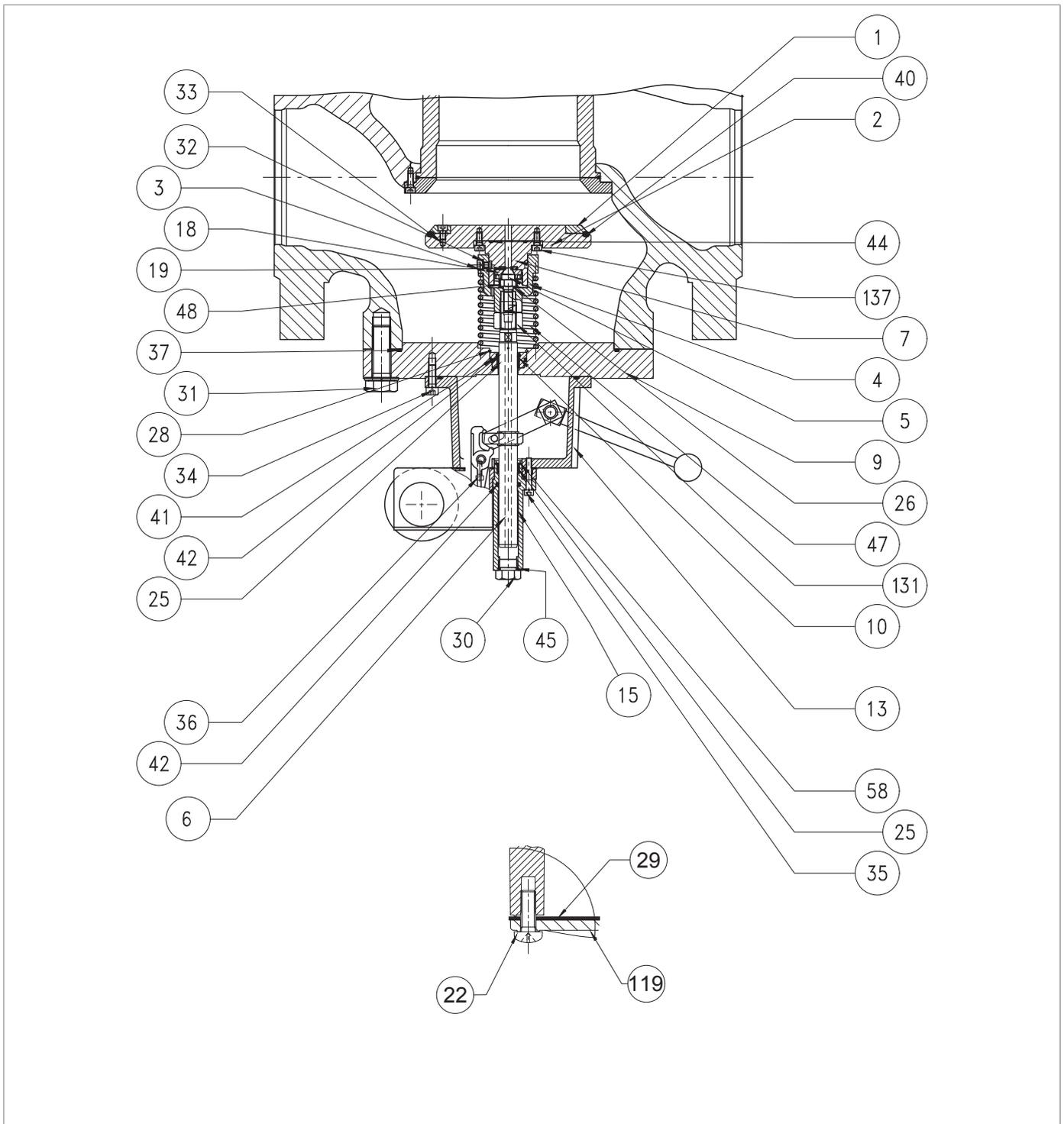
Fig. 9.73. Valvola di blocco incorporata SB/82 4"÷ 8"
