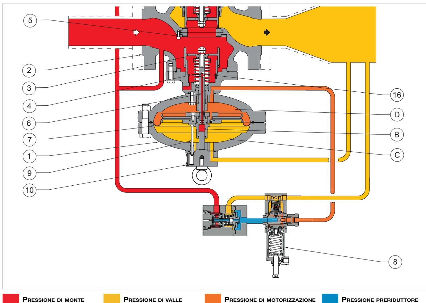
Fig. 4.6. Funzionamento monitor incorporato
