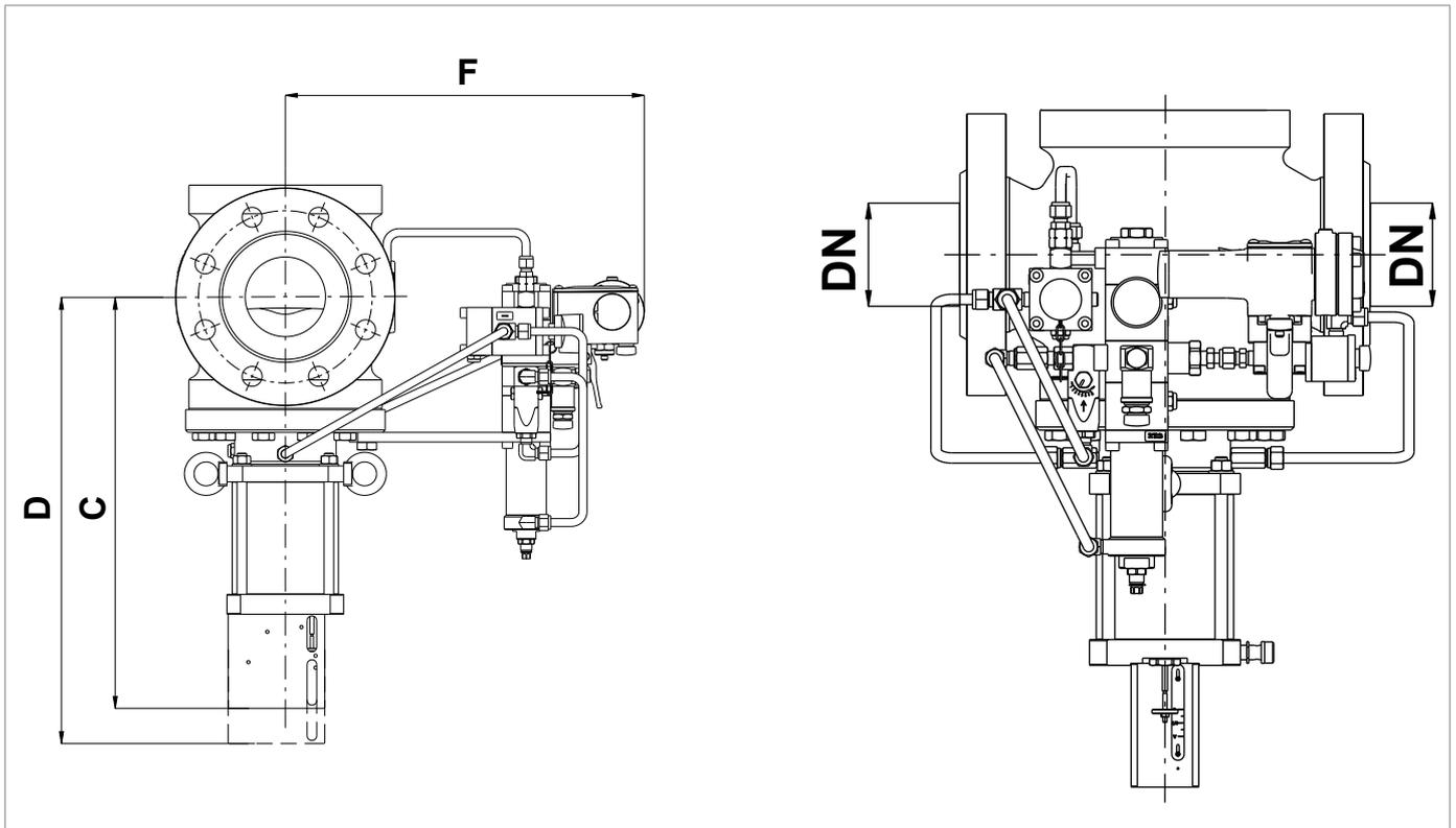
Fig. 5.18. Caratteristiche fisiche REFLUX 819/FO + HB/97
