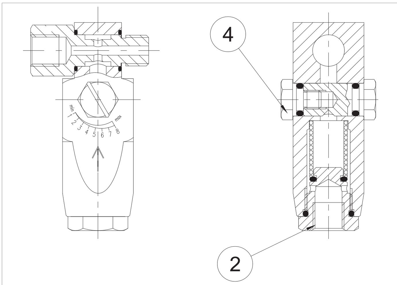
Fig. 9.52. Coppie di serraggio valvola di laminazione AR100
