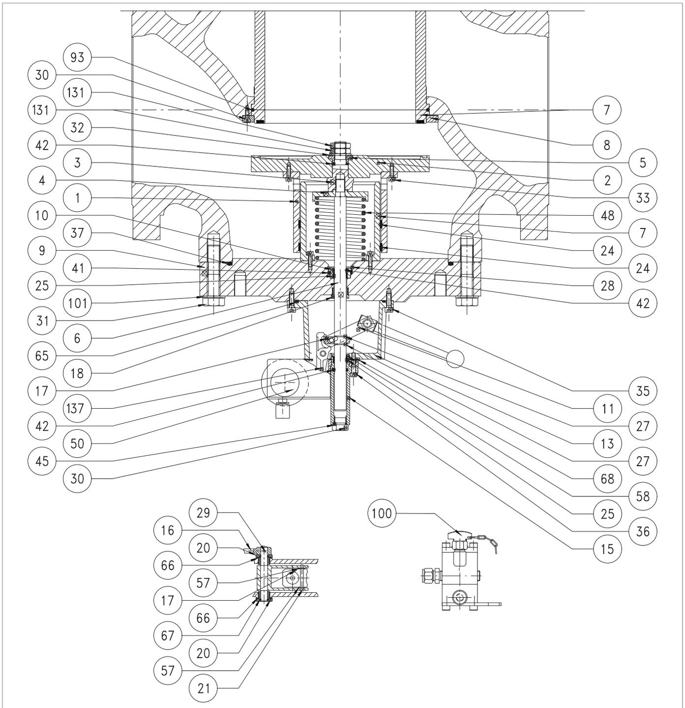
Fig. 9.74. Valvola di blocco incorporata SB/82 10"
