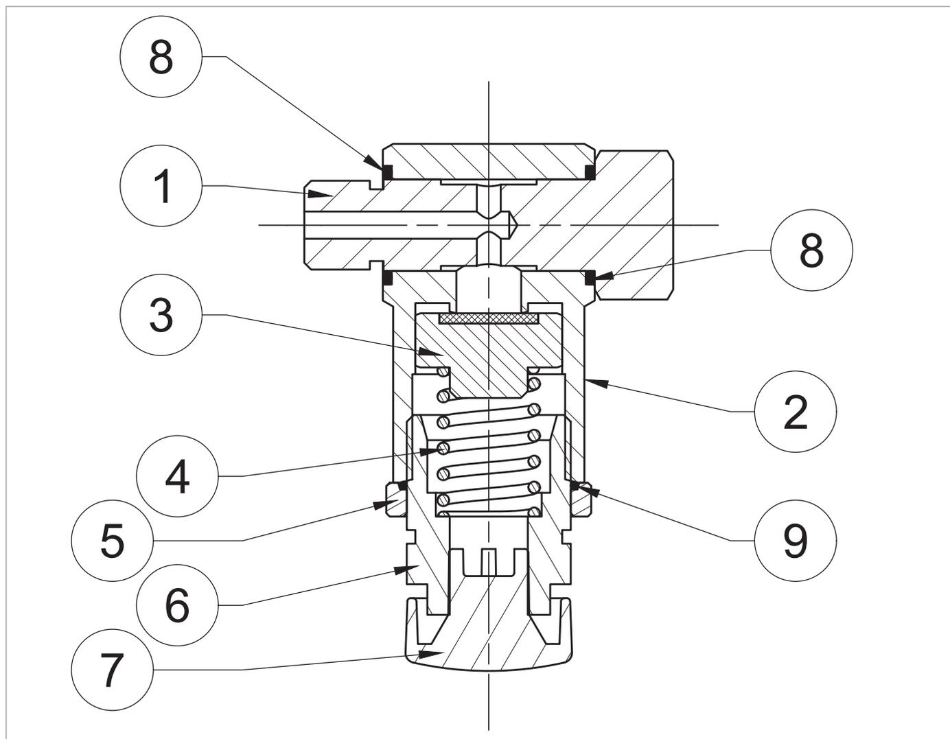
Fig. 9.83. Valvola di sicurezza VS/FI per LINE OFF 2.0
