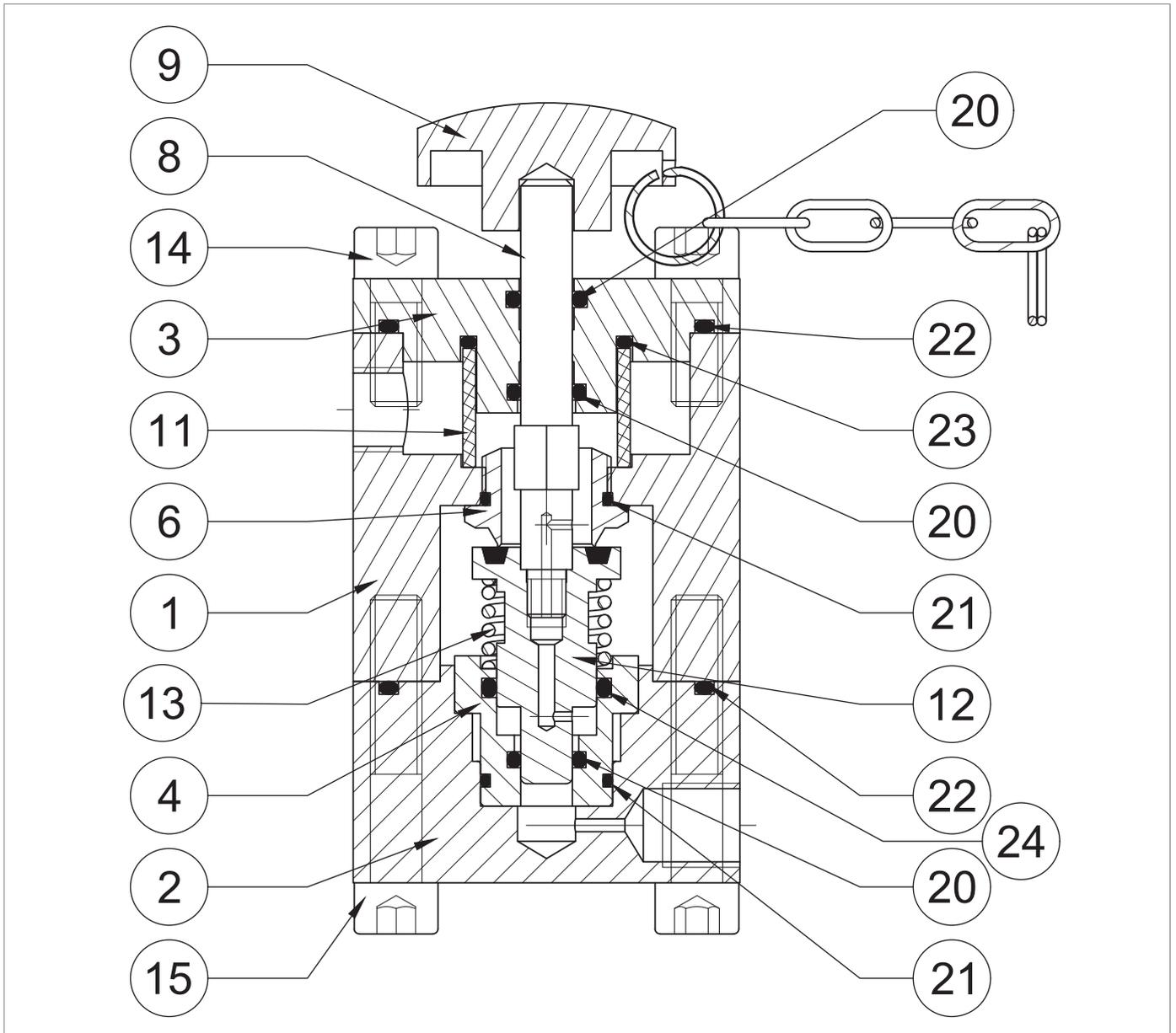
Fig. 9.80. Dispositivo bypass HP2/2
