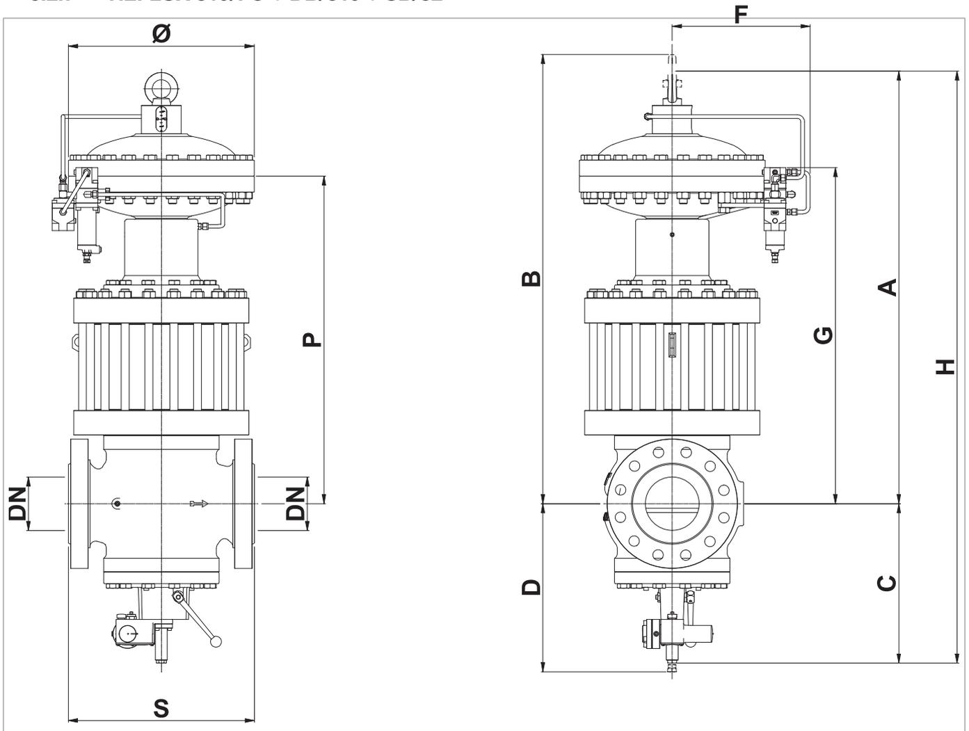
Fig. 5.20. Caratteristiche fisiche REFLUX 819/FO + DB/819 + SB/82
