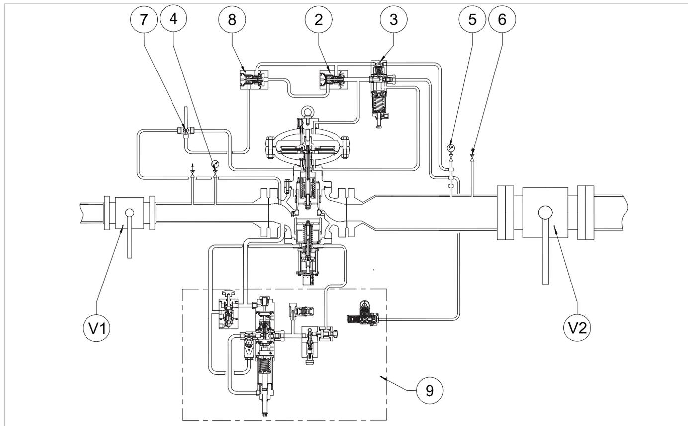
Fig. 8.35. Tenuta in chiusura della valvola di blocco incorporata HB/97
