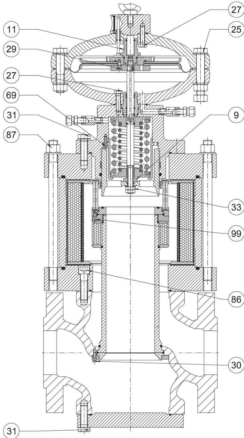
Fig. 9.40. Coppie di serraggio REFLUX 819/FO + Silenziatore DB/819
