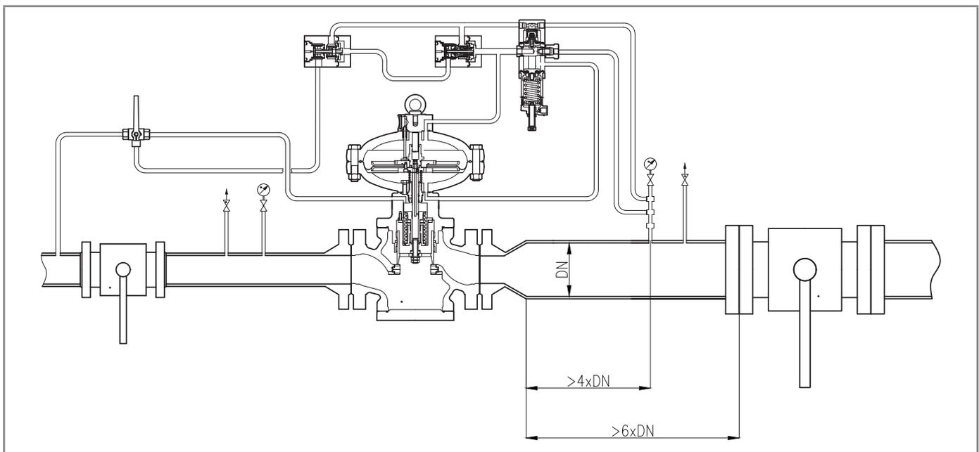
Fig. 6.26. Collegamento prese d'impulso alla tubazione di valle
