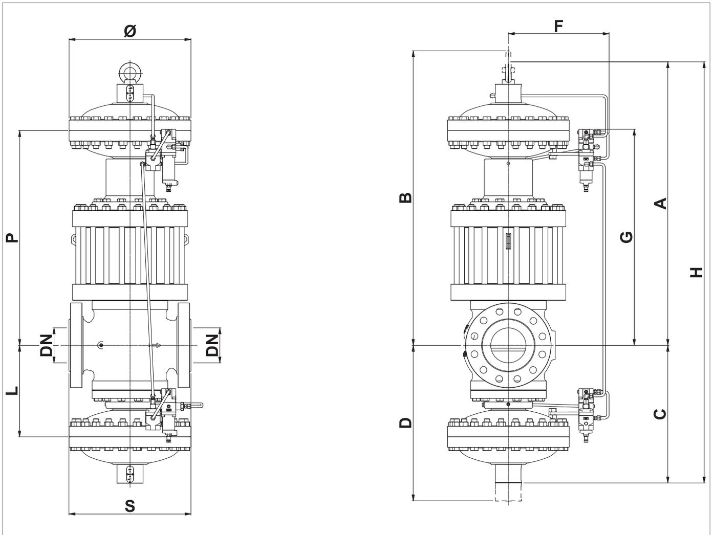
Fig. 5.19. Caratteristiche fisiche REFLUX 819/FO + DB/819 + PM/819
