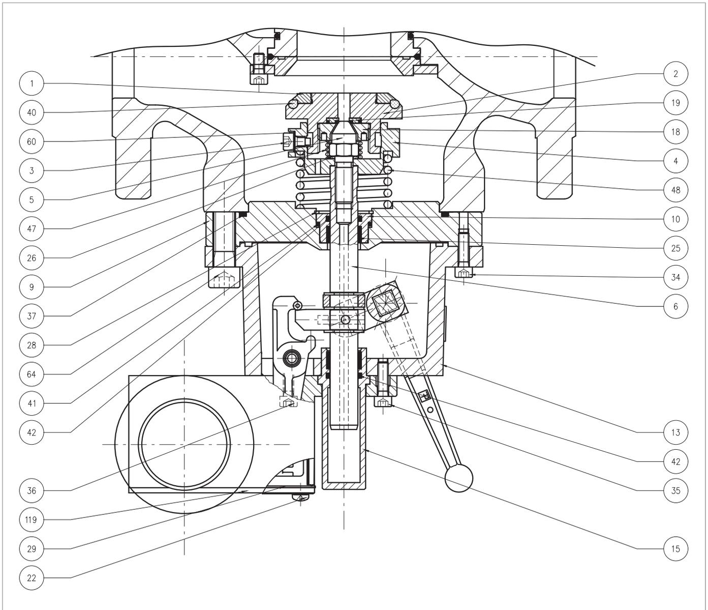
*Fig. 9.72. Valvola di blocco incorporata SB/82 2"÷ 3"*
