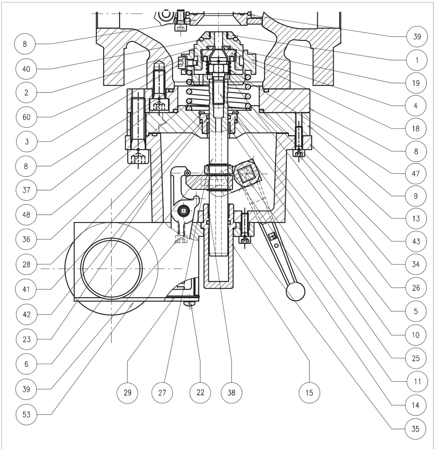
Fig. 9.71. Valvola di blocco incorporata SB/82 1"
