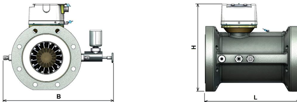
**Figura 17** Dimensioni del corpo in alluminio iM-TM
