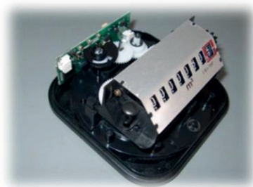
Figure 14 Totalisateur à codeur optique
