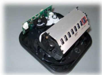
Figure 4 Totalisateur à codeur optique
