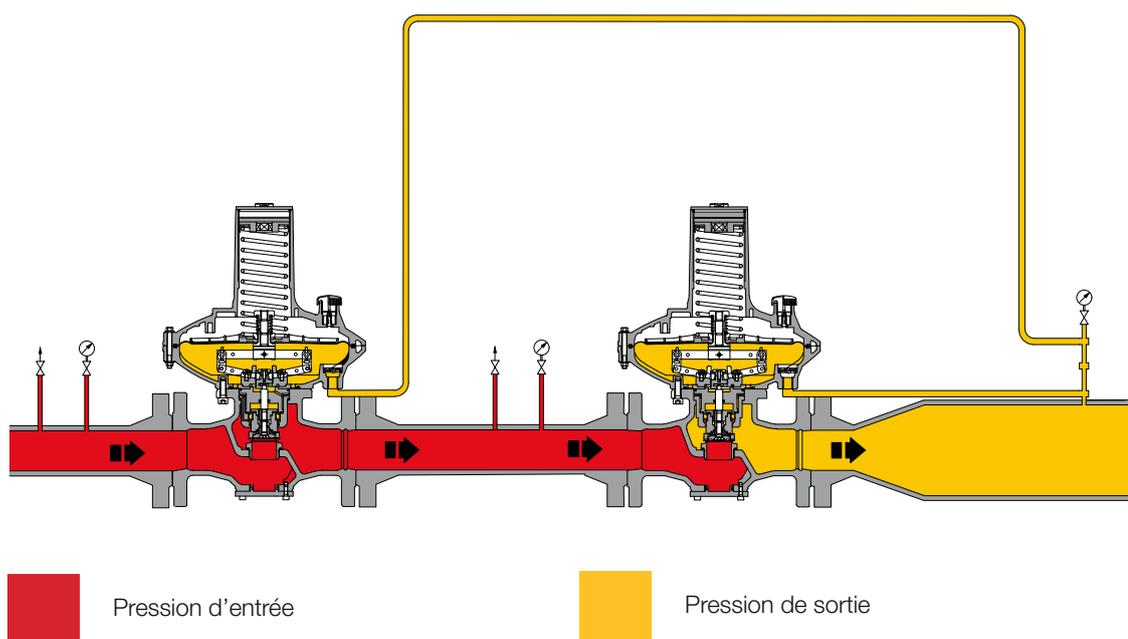
**Figure 5** Dival 600 avec fonction de monitor en ligne
