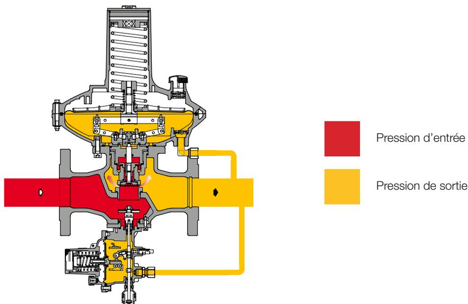
**Figure 7** Dival 600 avec vanne de blocage LA
